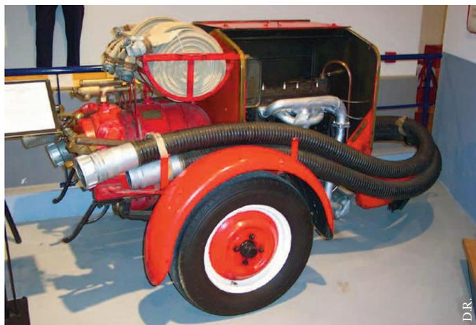
« Motopompe Remorquable S.A.M.D.I., construite par la Société Auxiliaire de Matériel d'Incendie, Moteur Chenard et Walker, 4 cylindres. Pompe S.A.M.D.I., rotative à pistons, système d'amorceur dit « petit cheval ». 2 aspiraux de 4 m., raccords à vis, 2 sorties de 70 mm. Châssis en tôle et roues à pneumatiques avec chambre à air. 1935. » Musée des Sapeurs-Pompiers de France, 76710 - MONTVILLE
